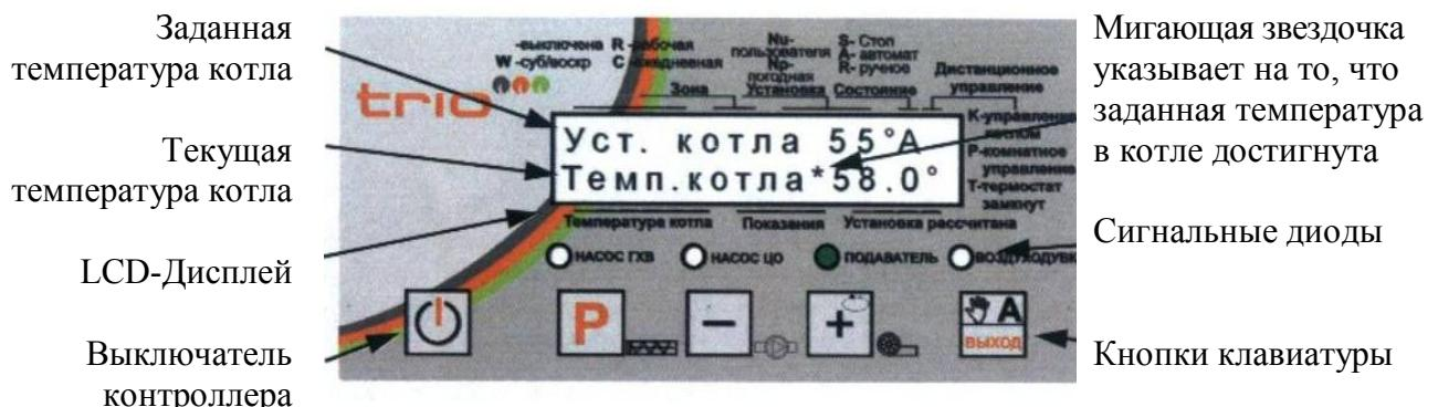
Рисунок 2 - Внешний вид передней панели контроллера
