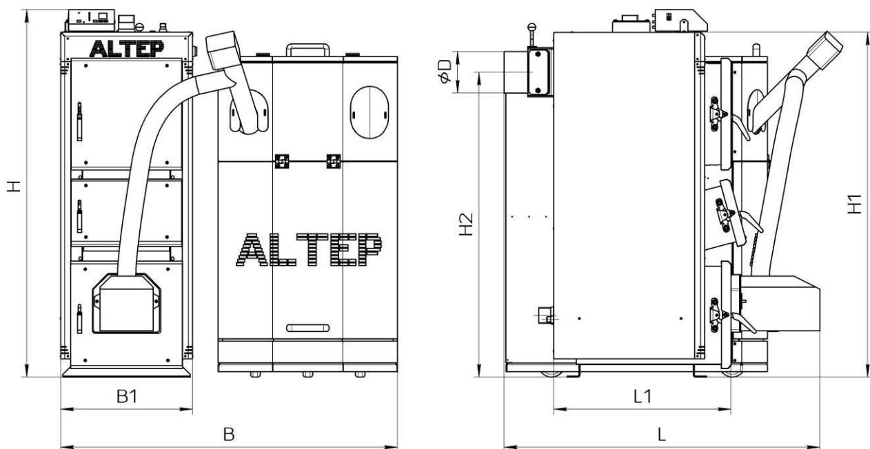
Рисунок 1 – Габаритный чертеж котла типа КТ-2Е-PG
