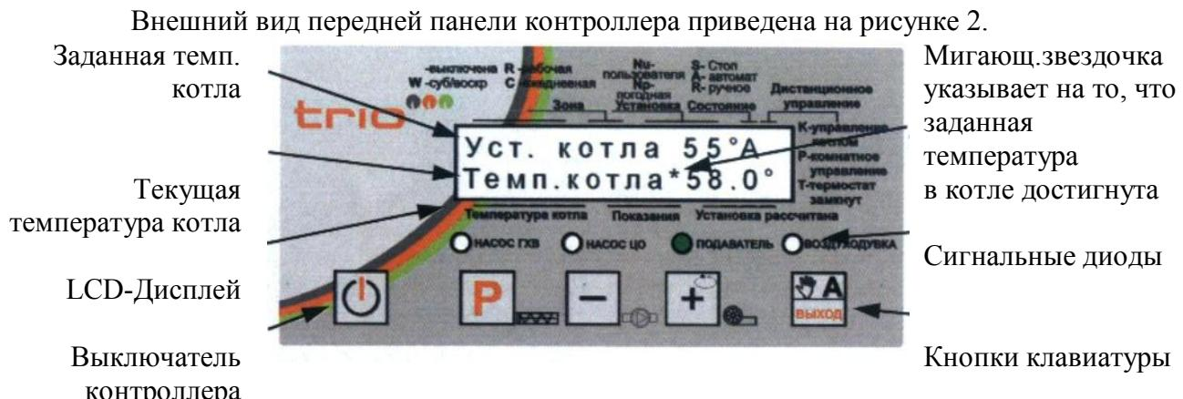
Рисунок 2 - Внешний вид передней панели контроллера
