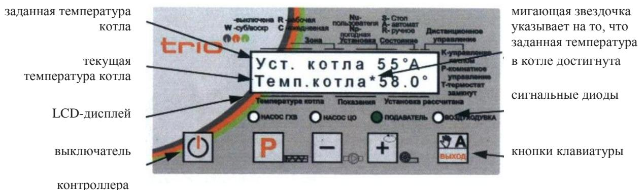
Рисунок 2 - Внешний вид передней панели контроллера
