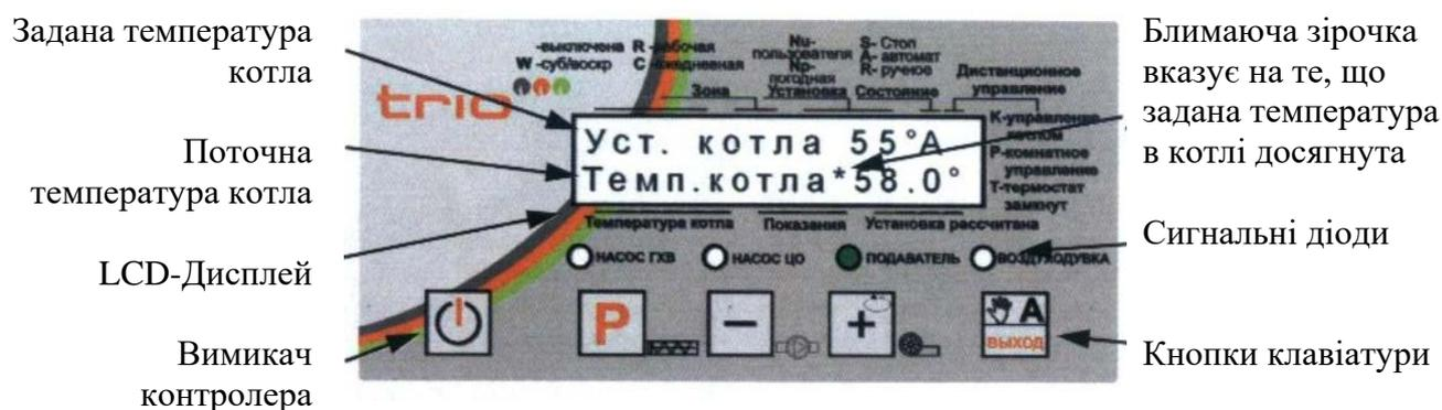
Рисунок 2 – Зовнішній вигляд передньої панелі контролера
