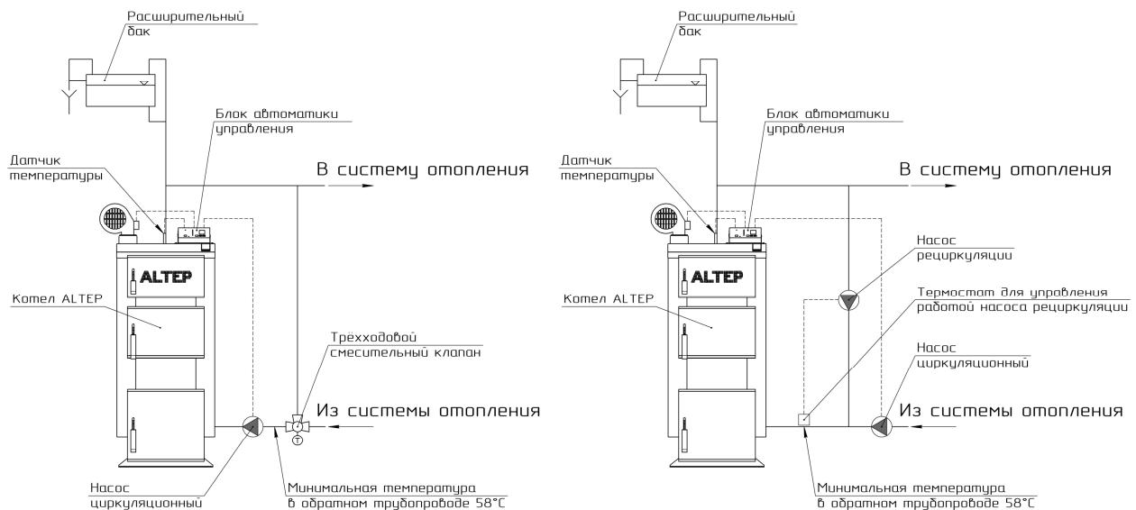
Рисунок 4 - Схемы подключения котла к системе отопления
